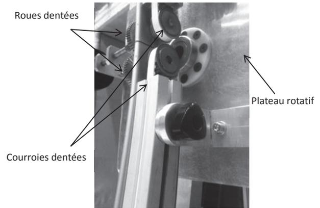
Figure 3 : Courroies et roues dentées du dispositif
