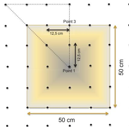
Figure 14 : Points de mesure au-dessus de la cavité
