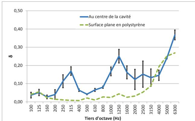
Figure 11 : Coefficient de diffusion acoustique au centre de la cavité – surface plane en polystyrène -  $\theta_s = 50^\circ$
