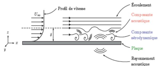
Figure 1 : Schéma en coupe d'une plaque excitée par une couche limite turbulente d'épaisseur  $\delta$  [9].
