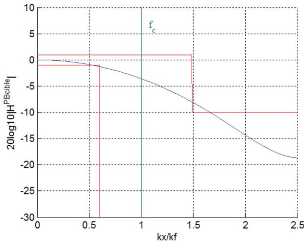
Figure 8 : Gabarit du filtre  $H^{PBcible}$ .
